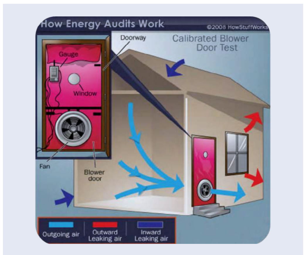
Figura 68. Esquema de Ensayo Blower Test. Fuente: lewisinsulation.com
