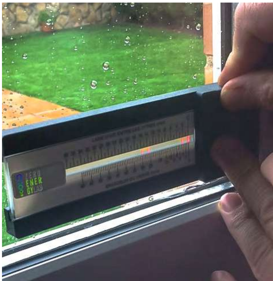
Figura 191: Medición composición vidrios de ventana.
