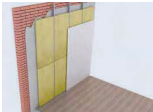
Figura 61. Aislamiento acústico en muro. Fuente: pladur-barcelona.es
