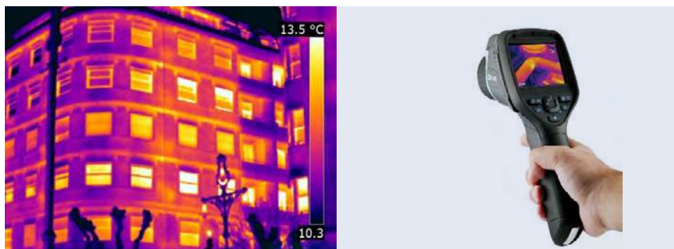
Figura 71. Termografía de un edificio. Elaboración propia.
